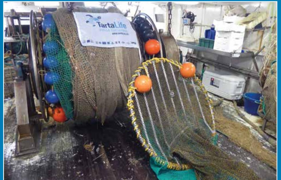
Figura 6, a-b. Flexgrid in fase di pesca e particolare di uno dei TED rigidi utilizzati durante le prove.
