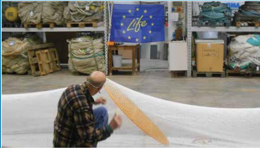
Figura 6, c. Particolare di uno dei TED rigidi utilizzati durante le prove.
