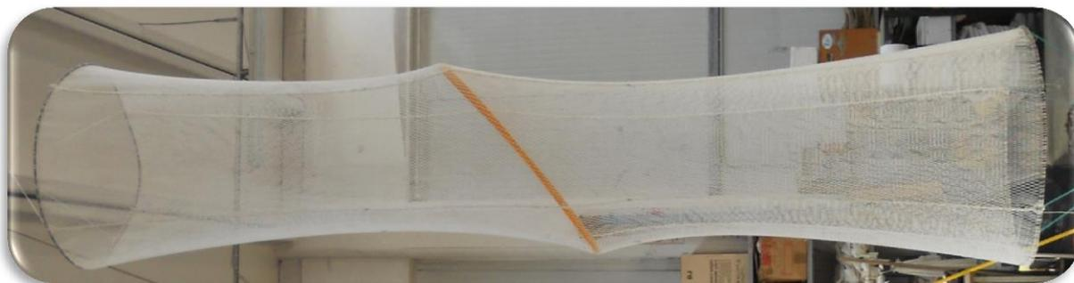
Importante montare il TED con un angolo compreso tra  $45^\circ$  e  $55^\circ$  rispetto all'asse longitudinale della rete.
